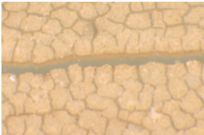
Die Makroaufnahme der Rohr-Innenwand zeigt neben dem Längsriss viele kleine Risse.
