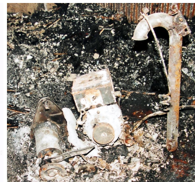
Brandursache: överschmutzter Schleifstaub im Auffangbeutel der Parkettschleifmaschine
